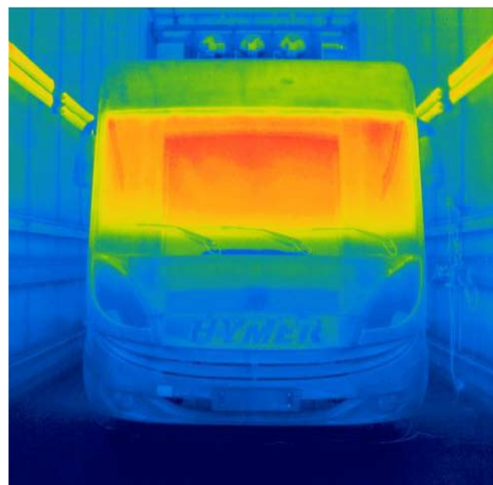
Oben: Wärmebild mit dem jeweilig dazugehörigen „Normalbild“. Mit der Wärmebildkamera ist der Wärmestrom der Konvektoren ersichtlich.
