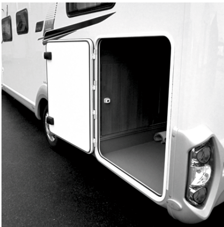
Kuva 18: Asuinosa, huoltoluukku ulkoa, esimerkki: Pieni säilytyslokero usein tarvittaville ajoneuvo- ja matkatarvikkeille
