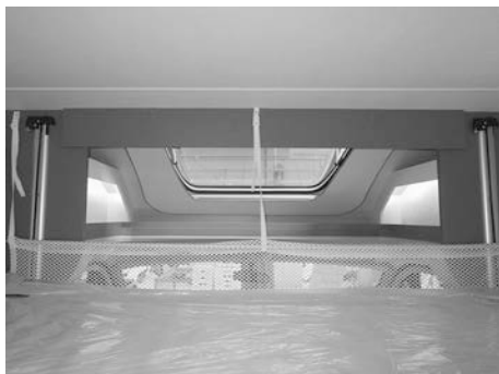
Abb. 167: Abgeseenktes Hubbett mit Rausfallschutz
