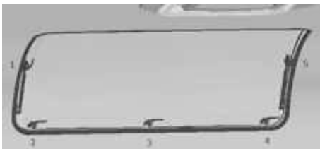
Abb. 31: Innenansicht des gewölbten Ausstellfensters mit fünf Drehriegeln
