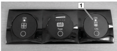
Abb. 92: Ein-/Aus-Schalter der Fußbodentemperierung
