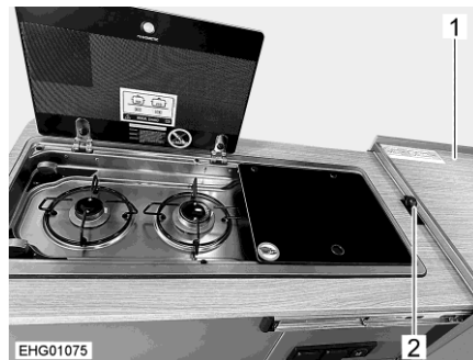
Kuva 55 Liesi, työtaso työnnetty sivuun
