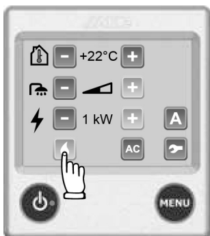
Abb. 162: Heizen mit Gas
