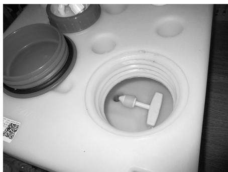
Abb. 92: Ablasstopfen im Frischwassertank
