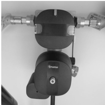
Abb. 71: Gasversorgung (mit Eis-Ex und Fernanzeige)
