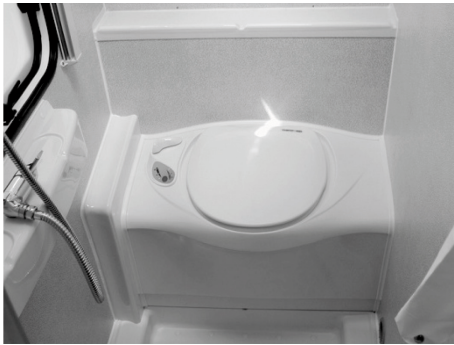
Abb. 46: Toilette, Beispiel fest installiert
