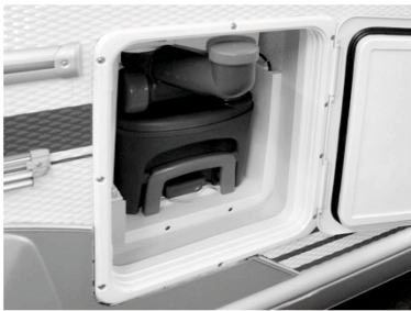
Abb. 47: Fäkalientank mit Spülwasser-Einfillstutzen
