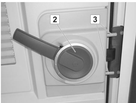
Abb. 17: Tür geschlossen und gesichert
