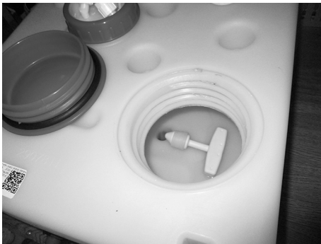
Abb. 102: Ablasstopfen im Frischwassertank
