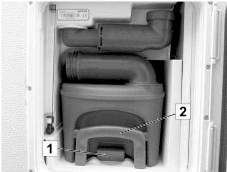
Abb. 192: Fäkalientank im Entsorgungsschacht
